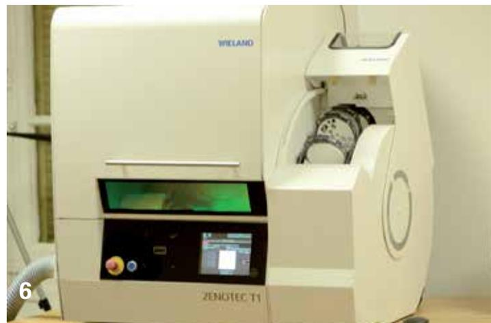
6. Exemple de machine d'usinage (machine d'établi).
